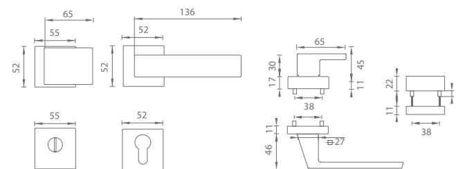
**i** Přesah cylindrické vložky od dveří může být maximálně 17 mm
